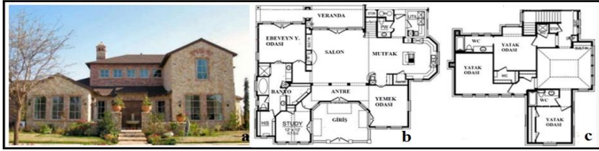
Şekil 27. Country evine ait a. dış görünüş, b. Zemin kat planı, c. 1. Kat planı ( https://www.thehousedesigners.com )
