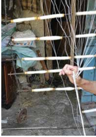
Fotoğraf 38. Çözgü İplikleri Üzerinde Ağızlık İşleminin Yapılması Fotoğraf: Meral Orhan.
