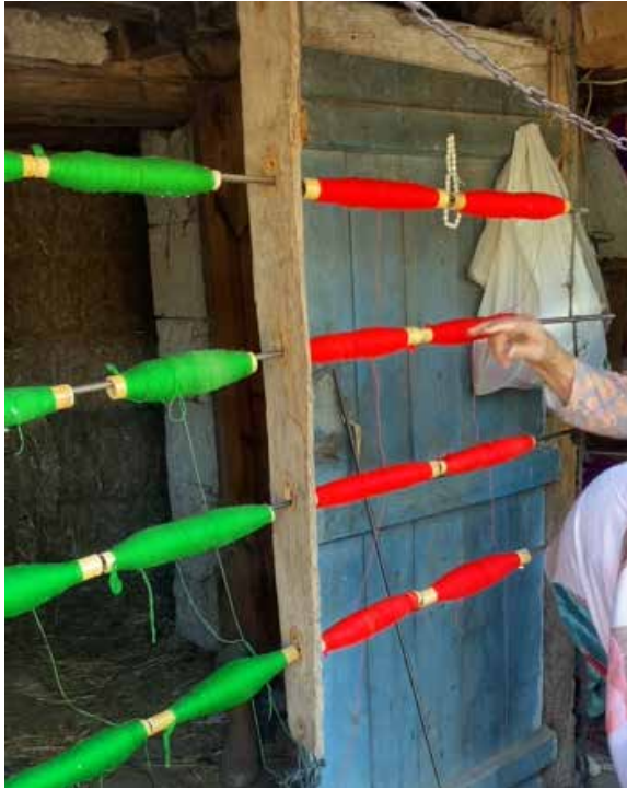
Fotoęraf 29. Çözüğü Çubuęuna Kalemlerin Takılması Fotoęraf: Meral Orhan
