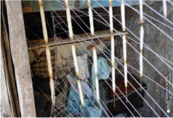
Fotoğraf 37. Çözgü Çubuğuna Kalemlerin Takılması Fotoğraf: Meral Orhan.
