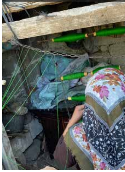
Fotoğraf 30. Çözü Çubuğuna Aparatına Takılan Metal Zincirden Kalemlerin Her Birinden Gelen İpliklerin Geçirilmesi Fotoğraf: Meral Orhan
