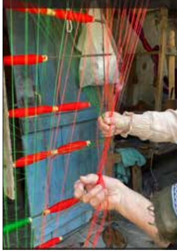
Fotoęraf 32. özgü İplikleri Üzerinde Ağızlık İřleminin Yapılması Fotoęraf: Meral Orhan.
